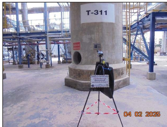
รูปที่ 4.23 การตรวจวัดปริมาณคาร์บอนไดออกไซด์ บริเวณ EO Scrubbing (T-311)
