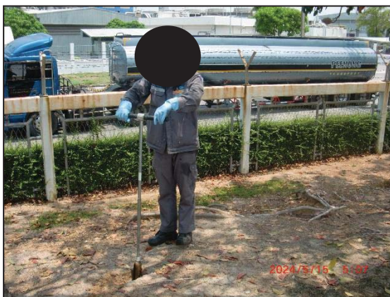
รูปที่ 4.11 การเก็บตัวอย่างดิน บริเวณริมรั้วด้านทิศใต้โครงการ (บ่อท้ายน้ำ (Down-gradient)) (MW05)
