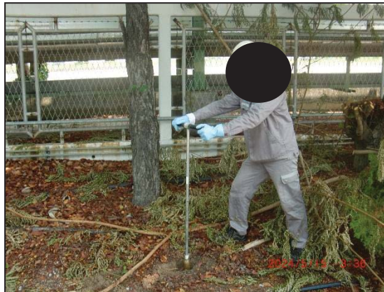
รูปที่ 4.12 การเก็บตัวอย่างดิน บริเวณริมรั้วด้านทิศตะวันตกโครงการ (บ่อกลางน้ำ (Middle-gradient)) (MW06)
