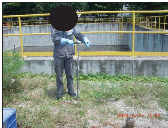
รูปที่ 4.13 การเก็บตัวอย่างดิน บริเวณแนวท่อใต้ดิน (MW07)
