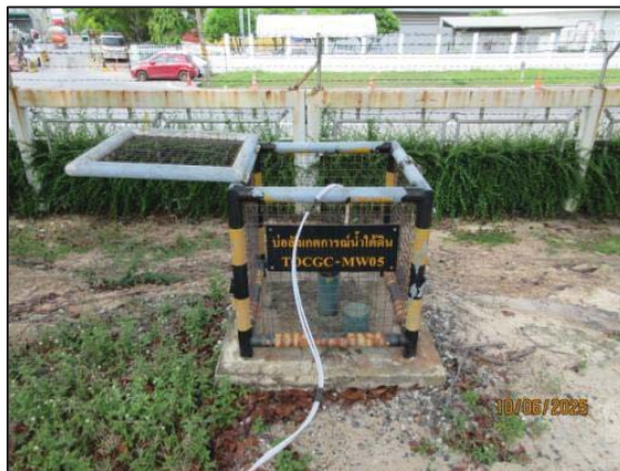
รูปที่ 4.7 การเก็บตัวอย่างน้ำใต้ดิน บริเวณริมรั้วด้านทิศใต้โครงการ (บ่อทำynnน้ำ (Down-gradient)) (MW05)
