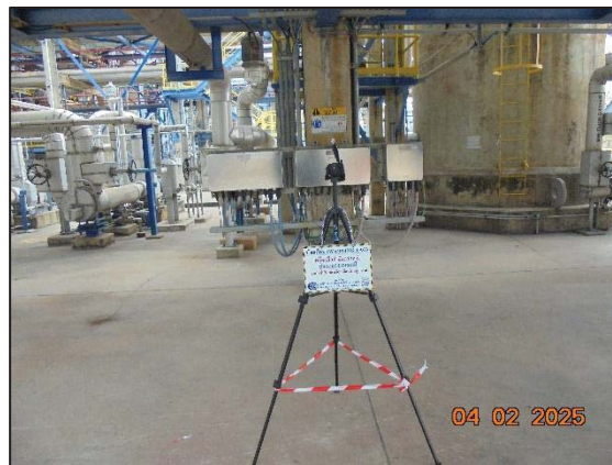
รูปที่ 4.27 การตรวจวัดปริมาณเอทิลีนออกไซด์ บริเวณ Ethylene Oxide Purification Unit
