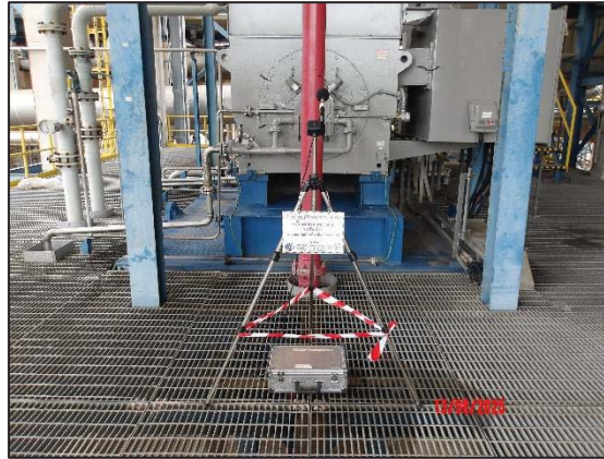
รูปที่ 4.17 การตรวจวัดระดับเสียงเฉลี่ยตลอดระยะเวลาการทำงาน บริเวณ Compressor Area : C-115
